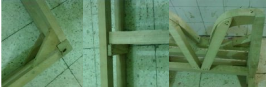
صورة رقم ( ٣١ ) مراحل تصنيع الهيكل الخشبي لوحدة الاريكة المكررة و تنتهي عند منتصف الموجة ليسهل تجميعها مع الاخرى
