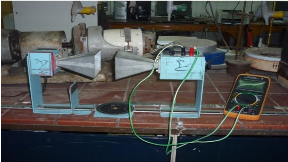
صورة (٢) توضح جهاز electromagnetic spectrum المستخدم في التجربة و متصل به جهاز القياس الملحق Digital Multimeter
