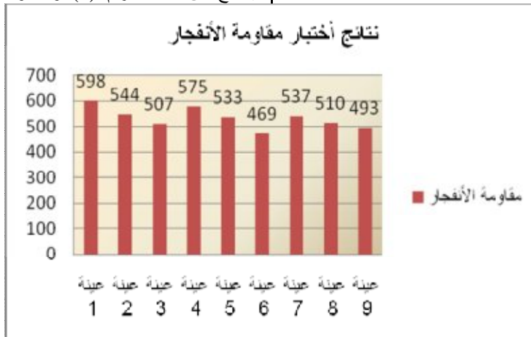
شكل ٥ : العلاقة بين تأثير إختلاف النمرة ونسب خلط الخامات على مقاومة الانفجار
