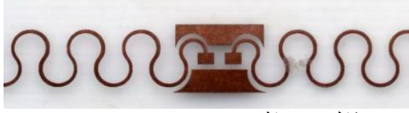
شكل "٤" هيكل Stiffener for SMD LED
