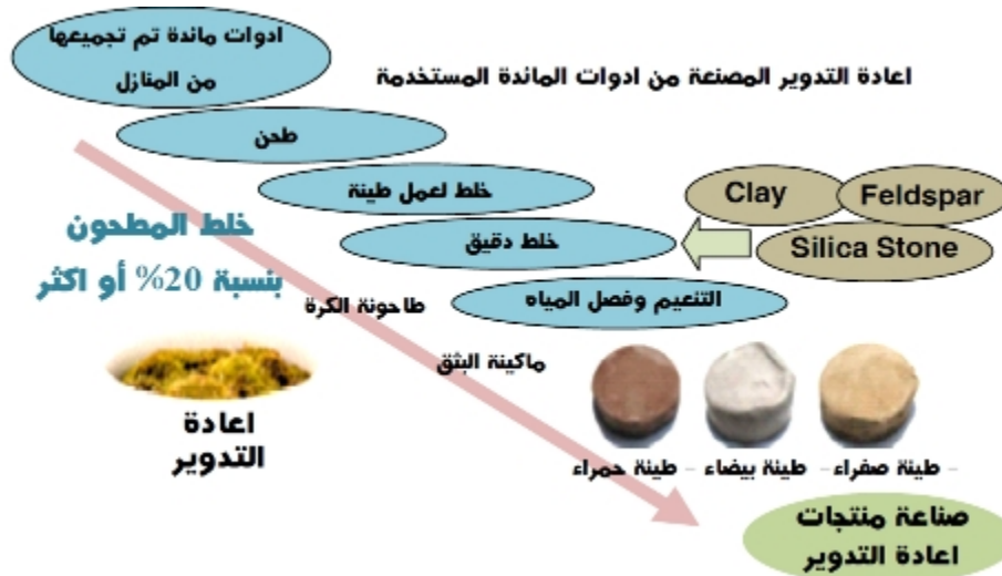
شكل (1) مراحل الإنتاج و المواد الخام المستخدمة في صناعة ادوات المائدة المعاد تدويرها
