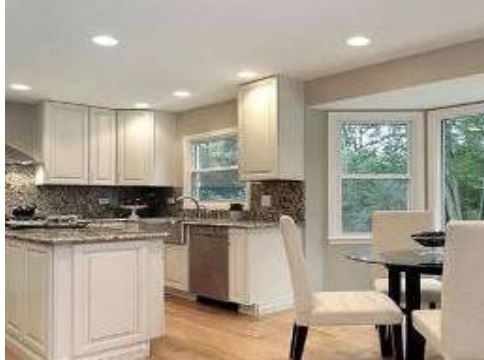
شكل (15) تصلح الإضاءة الغائرة Recessed Lighting للإضاءة المحيطة في المطبخ.
