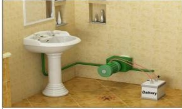
شكل ( 8 ) الوحدة المثبتة على مواسير الماء بها ريش المروحة وصندوق التروس ومولد الطاقة
