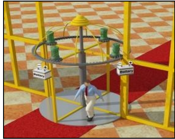
شكل ( 10 ) يوضح كيفية الاستفادة من الباب الدوار في توليد الطاقة
