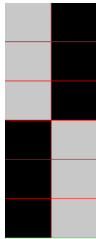
شكل (3) يوضح التركيب النسجي (سن ممتد 3/3 من السداء) ويستخدم في عمل تحديد بعض لوحات التصميم
